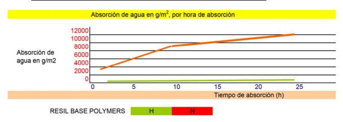
Absorción de agua de un recubrimiento base con, y otro sin polvos poliméricos dispersables hidrófobos, probeta de hormigón celular
